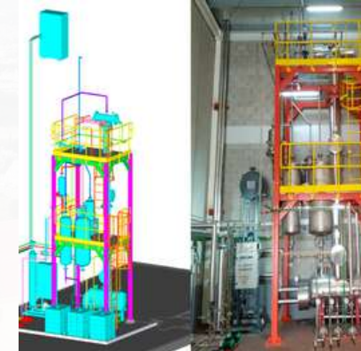
Projeto de enriquecimento de eucalipto através de destilação em coluna a vácuo
